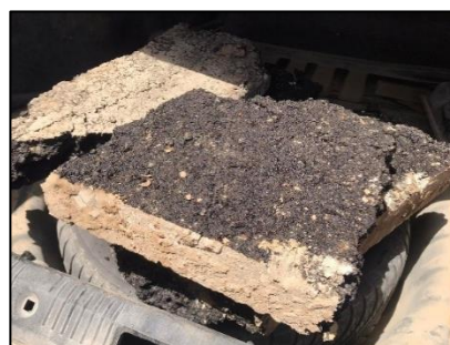
الشكل 2 استخراج الكتلة الإسفلتية
