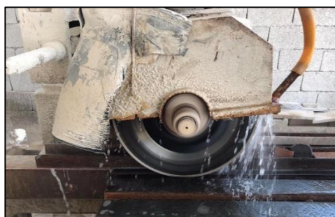
الشكل 3 جهاز قص وتسوية العينات
