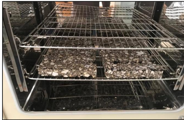
الشكل 5 العينات داخل فرن التقادم
