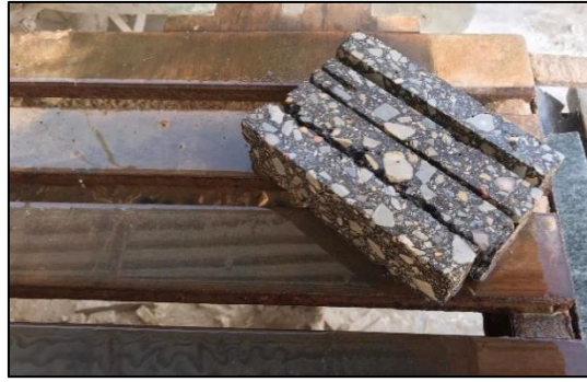
الشكل 4 يوضح العينة بعد القص و التسوية
