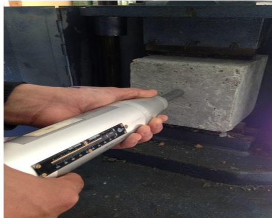
الشكل 4: طريقة إجراء اختبار مطرقة شميدت.
