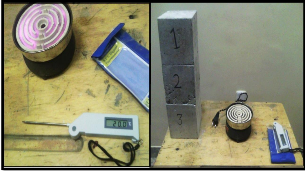
الشكل (5) : الأجهزة المستخدمة لقياس التوصيل الحراري للعينات
